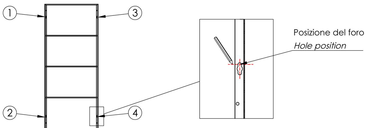
**26-** Rimuovere la struttura e forare nei punti segnati a matita utilizzando un trapano, inserire i tasselli nei fori e avvitare le viti nei tasselli.
