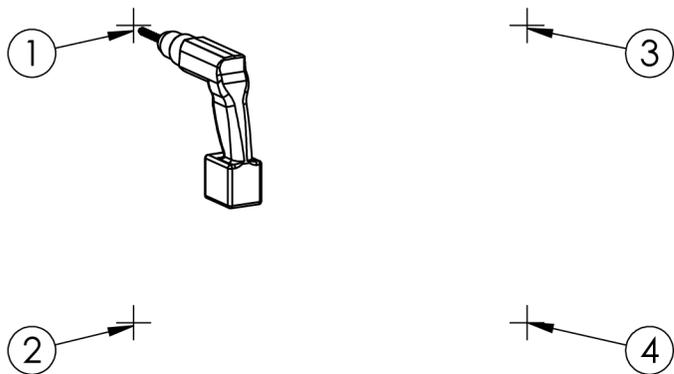
**8-** Mettere la struttura in posizione e avvitare le viti nei tasselli per fissarla.
