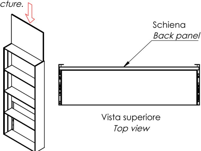
**28-** Inserire gli spessori sul retro della schiena in prossimità dei fori svasati presenti sui montanti e fissare la schiena con le viti fornite.
