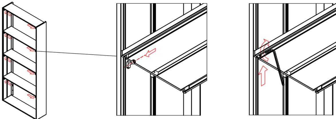
**25- Per schiene con spessore inferiore a 18mm:** posizionare la struttura nella sua posizione finale, verificare la verticalità dei montanti e segnare con una matita i punti di foratura per i tasselli.
