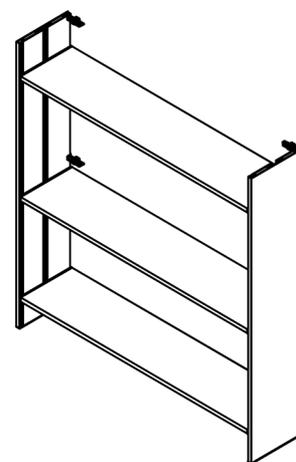
**6-** Posizionare la struttura assemblata nella sua posizione finale e verificare la verticalità dei montanti. Utilizzare una matita per segnare sul muro la posizione dei fori per i tasselli.
