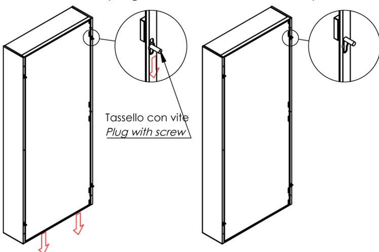
**30b-** Per schiene con spessore maggiore di 18mm fissare il modulo utilizzando una barra reggipensili, o soluzioni analoghe.
