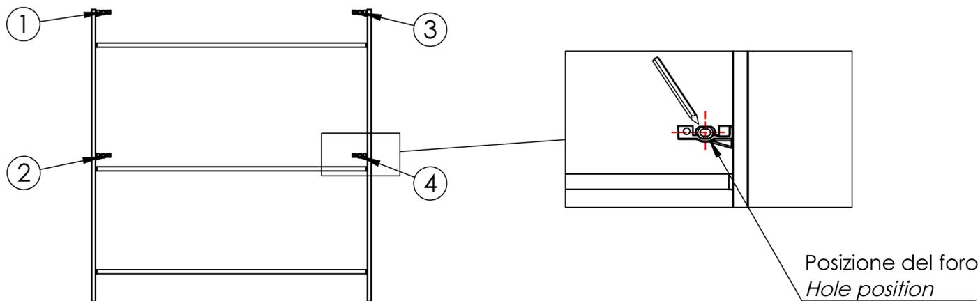
**7-** Rimuovere la struttura e forare nei punti segnati a matita utilizzando un trapano, inserire i tasselli nei fori.
