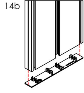
**15-** Inserire il ripiano inferiore verticalmente, farlo scorrere fino in fondo e bloccarne lo scorrimento facendolo ruotare in senso orario in prossimità della posizione finale. Verificare l'orizzontalità del ripiano.
