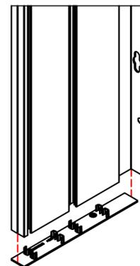
**22-** Inserire il ripiano inferiore verticalmente, farlo scorrere fino in fondo e bloccarne lo scorrimento facendolo ruotare in senso orario in prossimità della posizione finale. Verificare l'orizzontalità del ripiano.
