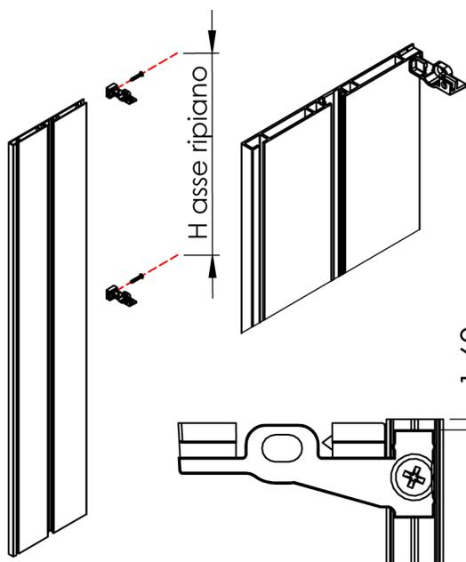
**1-** Fissare l'elemento di connessione a muro al profilo verticale usando le viti fornite. Fissarne uno per ogni ripiano che deve essere inserito, tranne per quello inferiore.
